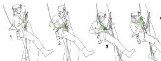
Imagem 19 – Sequência de passos para passagem de um fraccionamento a Jumar. Fonte: Catálogo da Petzl 2009
