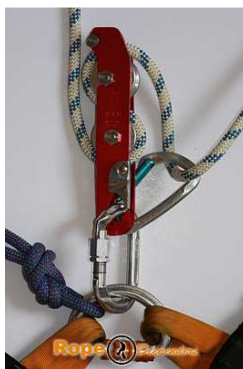
Imagem 11 – Montagem da corda no descensor com mosquetão de apoio. Fonte:
