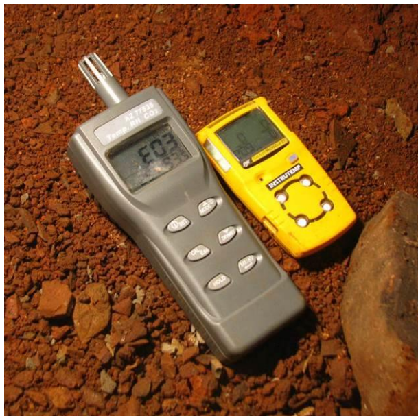
Figura 2 – Medidor portátil de CO 2 e detector multigases no salão de entrada da Lapa do Sufoco, durante o levantamento das condições de qualidade do ar da caverna.
