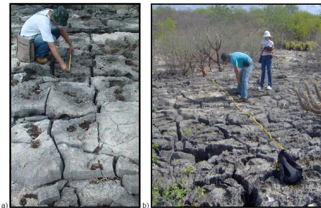
Figura 5 – Levantamento sistemático das famílias de fraturas pelo método da linha.
