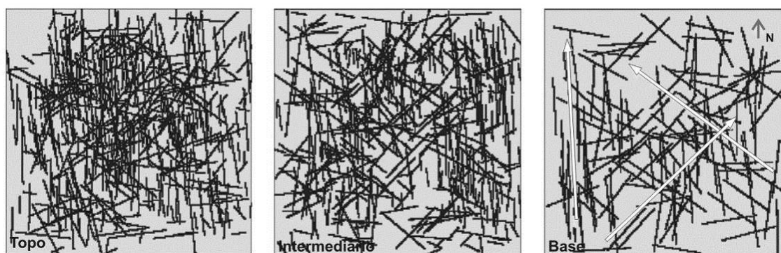
Figura 7 – Simulação do plano XY, em diferentes profundidades, o topo, onde predominam fraturas de pequena profundidade de direção N-S; o centro, porção intermediária; e a base, que representa as fraturas muito profundas ao longo das três direções preferenciais: NW-SE, NE-SW e N-S.
