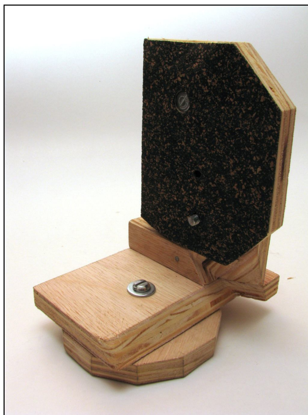
Fig. 2: Cabeça de tripé panorâmica, confeccionada em madeira e cortiça (baseada principalmente no modelo de Arodrix, 2005) para a Canon PowerShot S5 IS. A câmera é posicionada na orientação de “retrato”, quando no plano horizontal.
