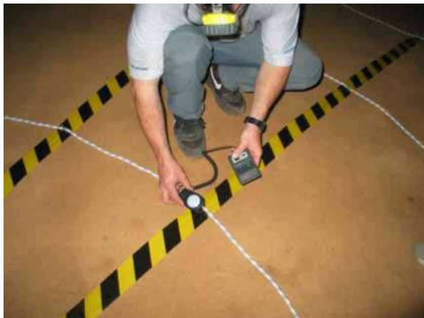
Detalhe da amostragem com o Luxímetro Amostragem no ponto de coleta de lux
