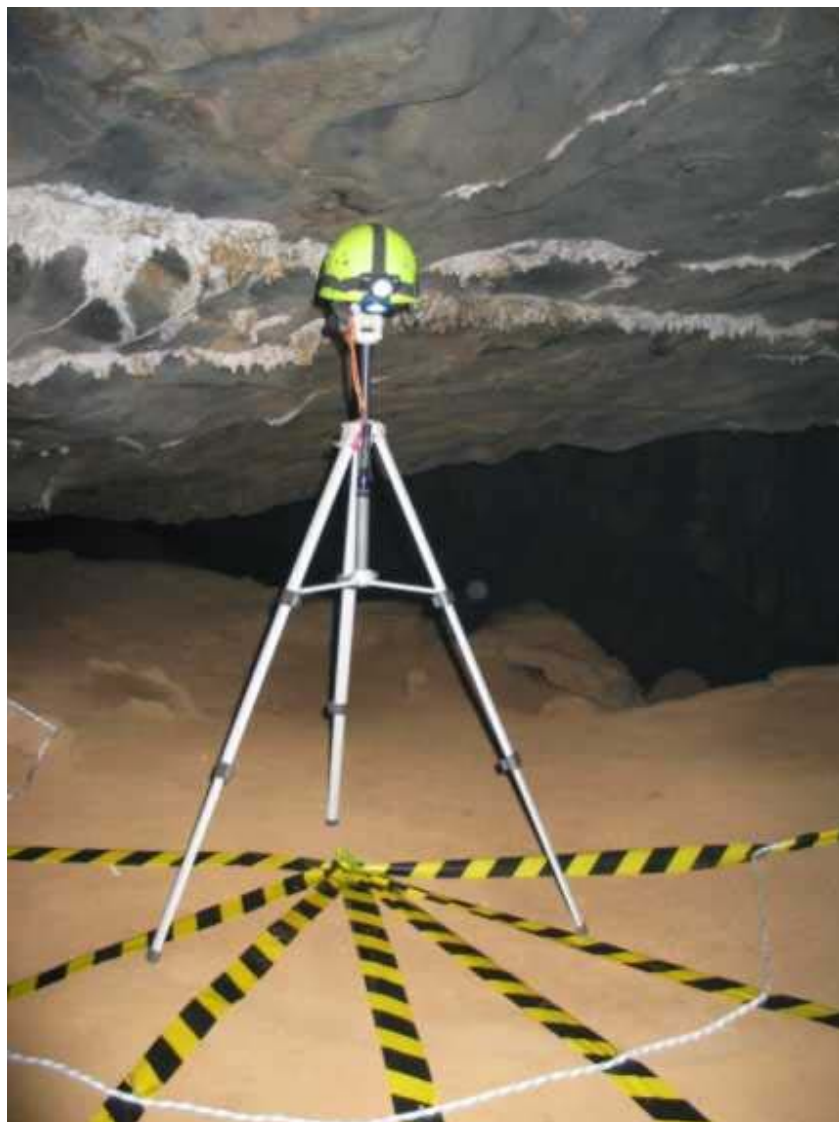
Lanterna de Led Capacete instalado sobre o Tri-pé (altura do espeleólogo)
