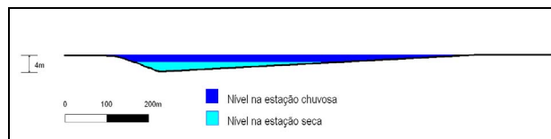
Figura 4: Perfil esquemático da Lagoa do Vânico,
