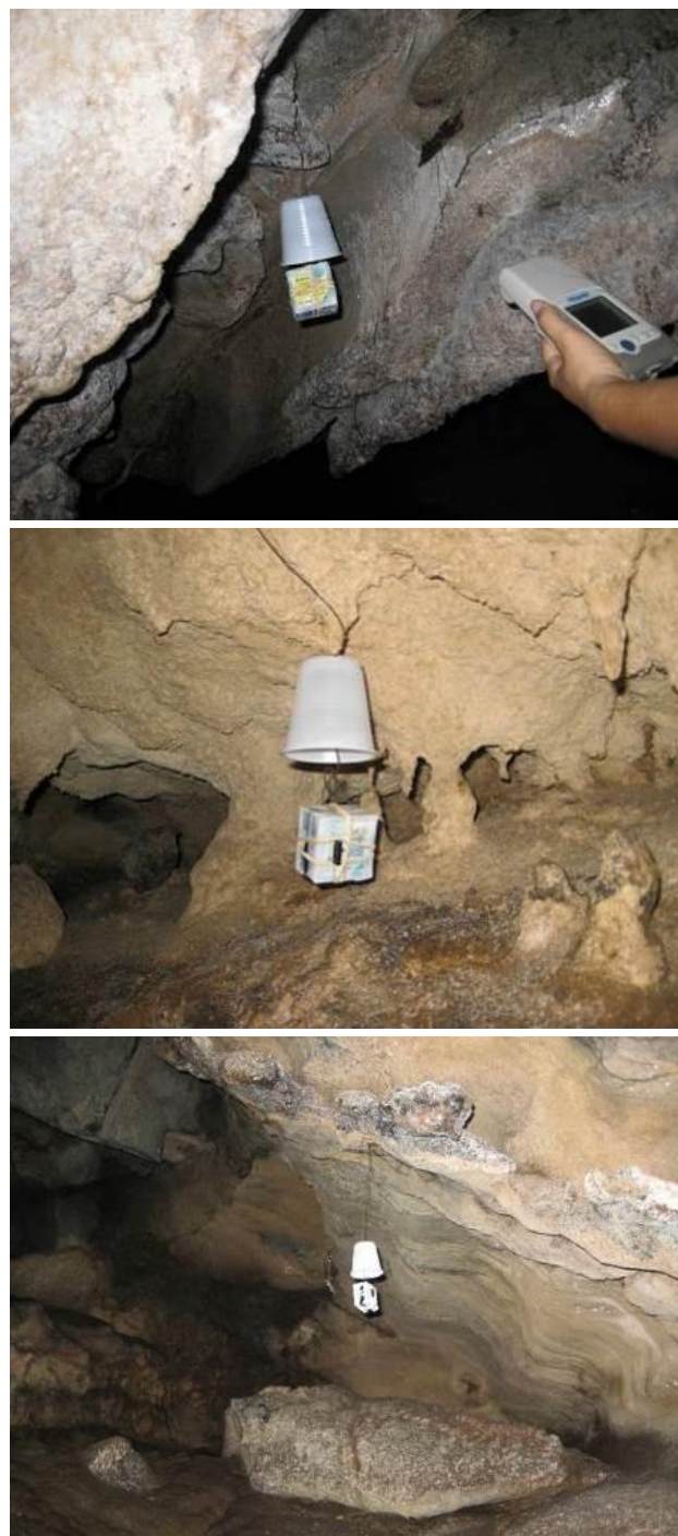
Figura 2 – Pontos de instalação dos termo-higrômetros na Gruta Jane Mansfield (Organização e fotografias: Bárbara N. Rocha, 2010).
