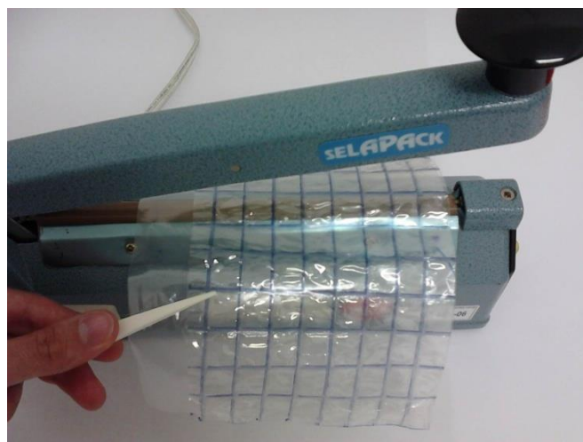
Figura 4.2 - Confeção dos invólucros de polietileno [Imagem de próprio autor].
