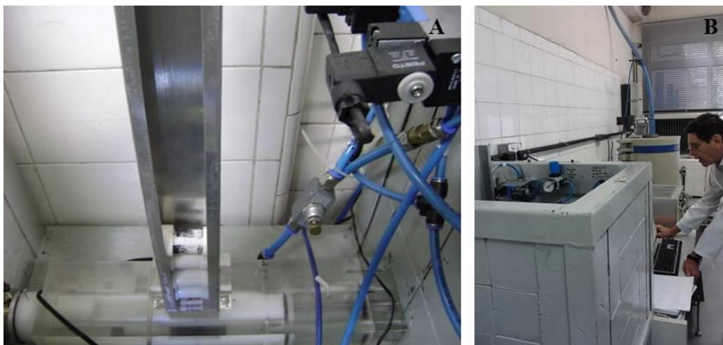
Figura 4.6 - Trocador automático (A) e conjunto trocador/detector (B) [Imagem de próprio autor].
