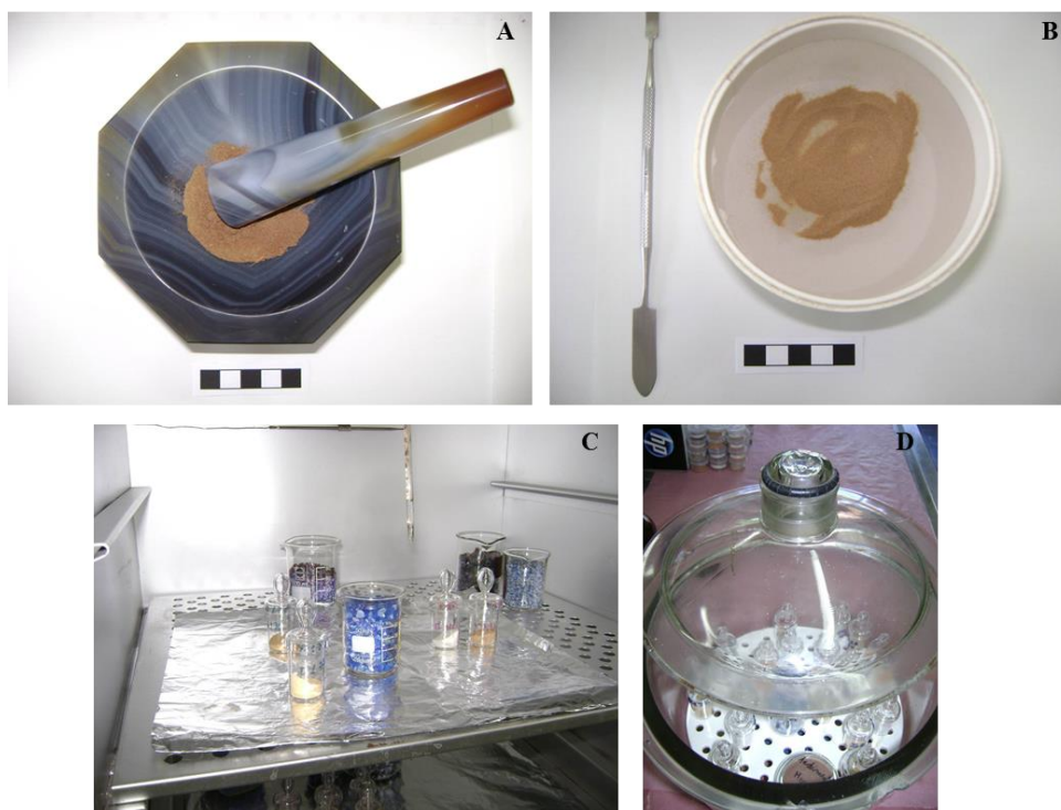
Figura 4.3 - Etapas de preparo de amostras utilizadas em INAA [Imagem de próprio autor].
