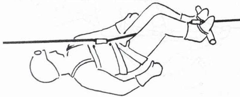
Fig.12. Inchworm Rig.
